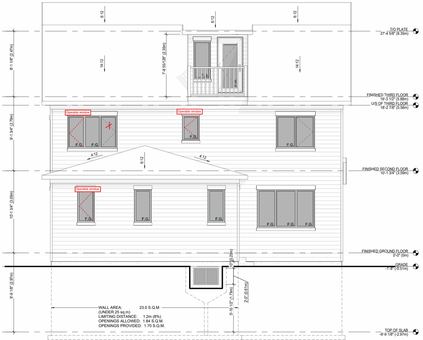
**DD - B - REAR ELEVATION**
