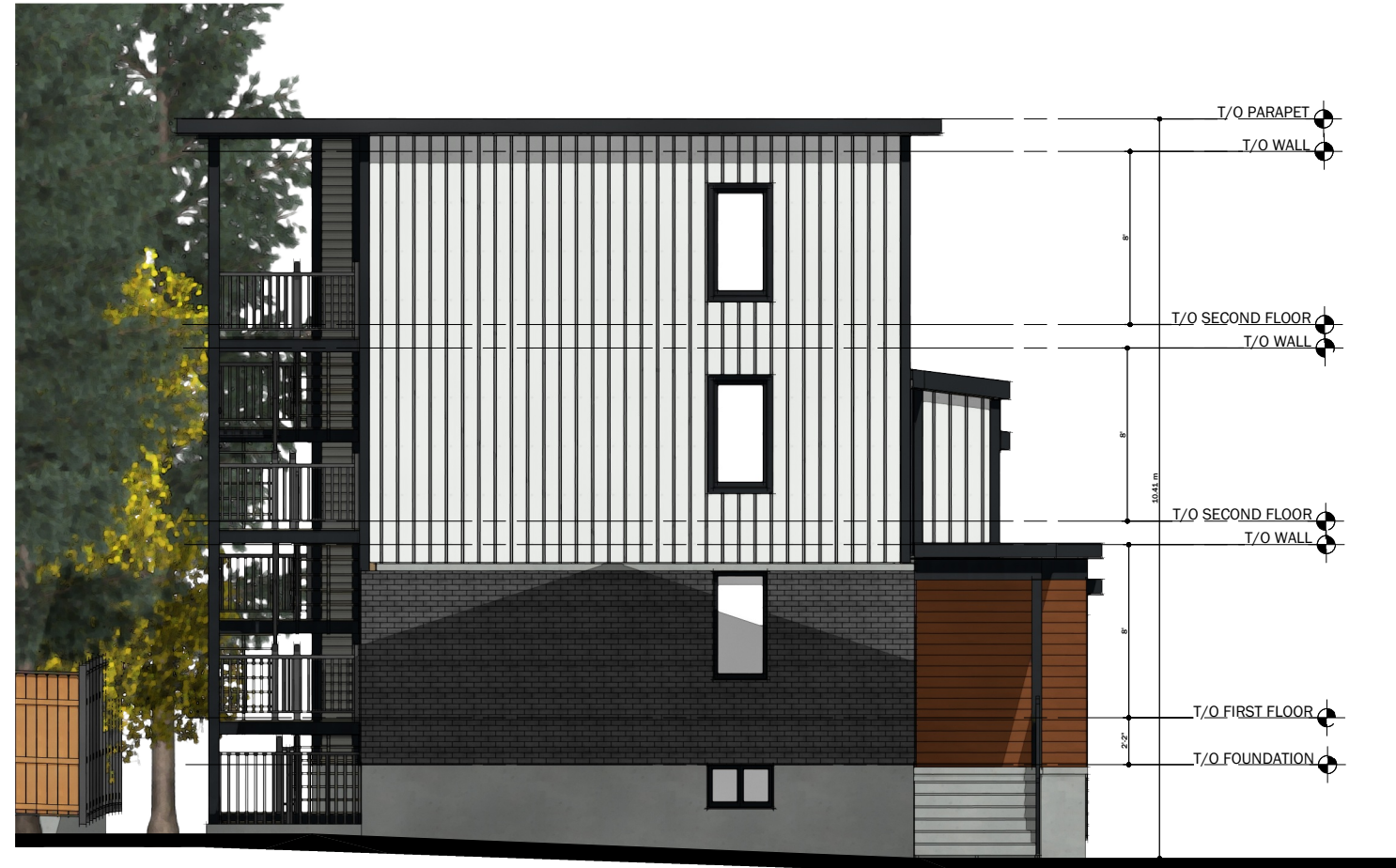
ELEVATION - WEST SCALE: 1:100
