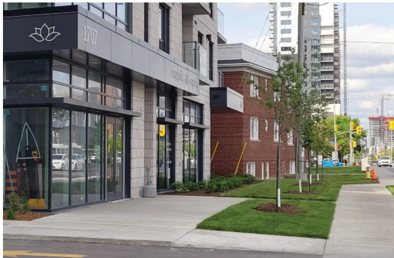
Figure 15 Un trottoir de béton de 2,0 mètres de largeur est aménagé dans l'emprise. D'autres allées piétonnières sont aménagées pour assurer la liaison avec le trottoir et avec les entrées des aménagements de plain-pied.
