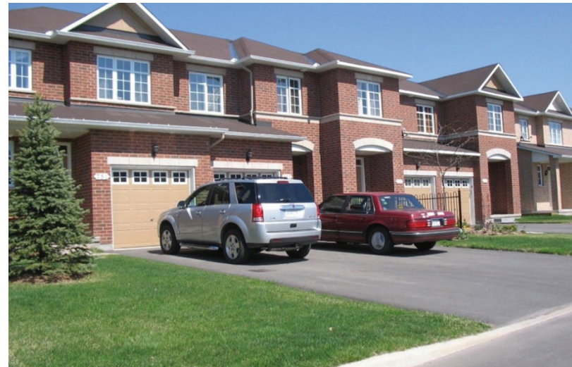
Figure 66 : S'il y a moins de bateaux de trottoir, il y a moins de trottoirs interrompus.
