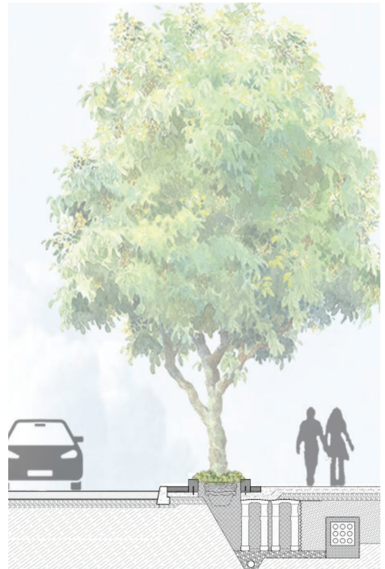
Diagramme 5 : La cellule de sol Silva Cell est l'une des méthodes auxquelles on fait appel pour planter des arbres dans les zones de contraintes. Cette méthode de conception s'inspire du concept général de la cellule Silva.
