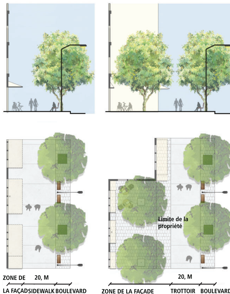
Diagramme 4 : Vue en coupe et plan du paysage urbain représentant le boulevard, le trottoir et la zone de la devanture des commerces de détail (zone de la façade).
