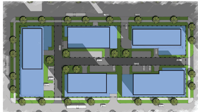
Diagramme 19 : Représentation conceptuelle de l'aménagement selon un plan directeur, dans lequel le stationnement est situé en sous-sol et les autres places de stationnement, ainsi que les points d'embarquement et de débarquement sont situés à l'intérieur du site de l'aménagement.
