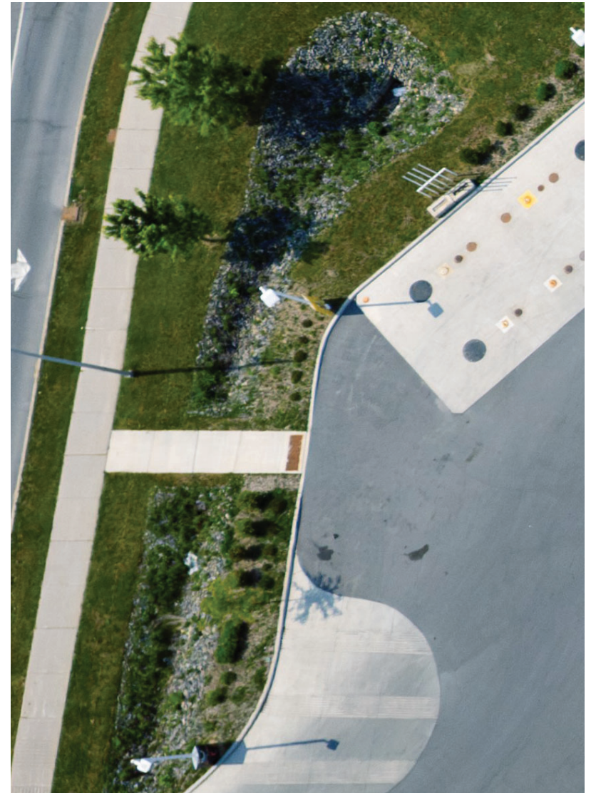
Figure 22 : Cette zone végétalisée permet de recueillir et d'emmagasiner les eaux pluviales pour réduire le ruissellement de ces eaux.
