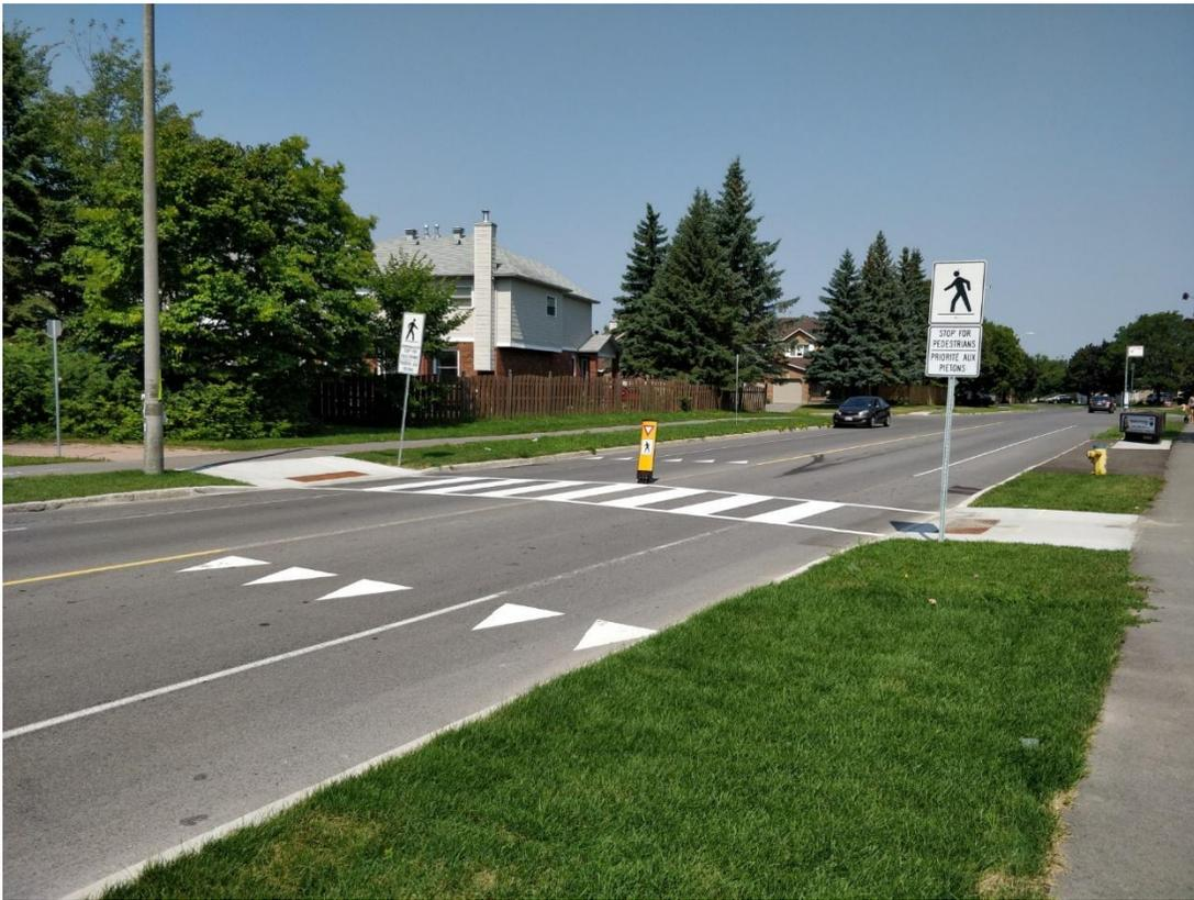
**Figure 9 – Photo d’un passage pour piétons de type D sur The Parkway, à Kanata**
