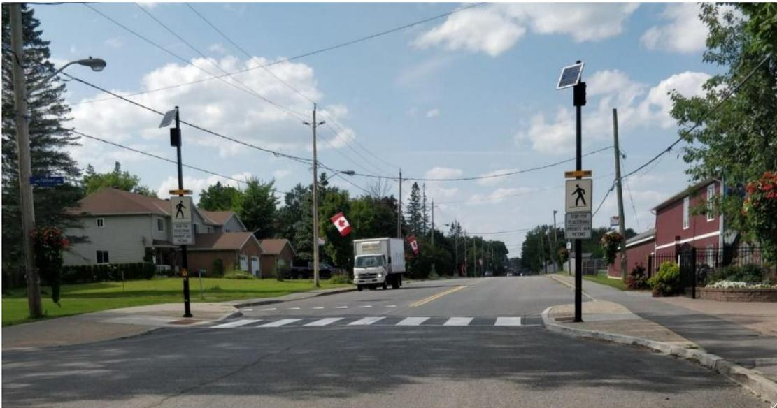
**Figure 5 – Photo d'un passage pour piétons de type C sur le chemin Carp, dans le village de Carp**
