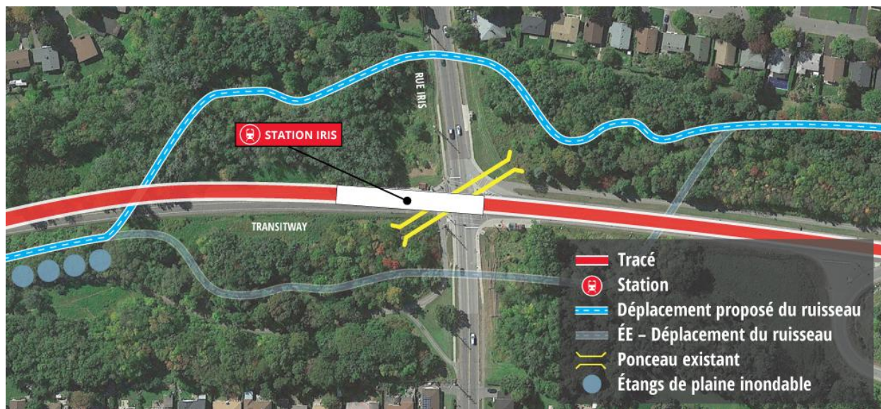
Figure 3 : Nouveau tracé du ruisseau Pinecrest à la Station Iris
