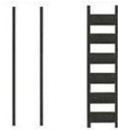
Figure 6 – Marquage de chaussée indiquant un passage pour piétons
